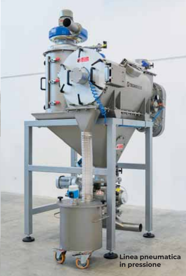
Linea pneumatica in pressione
